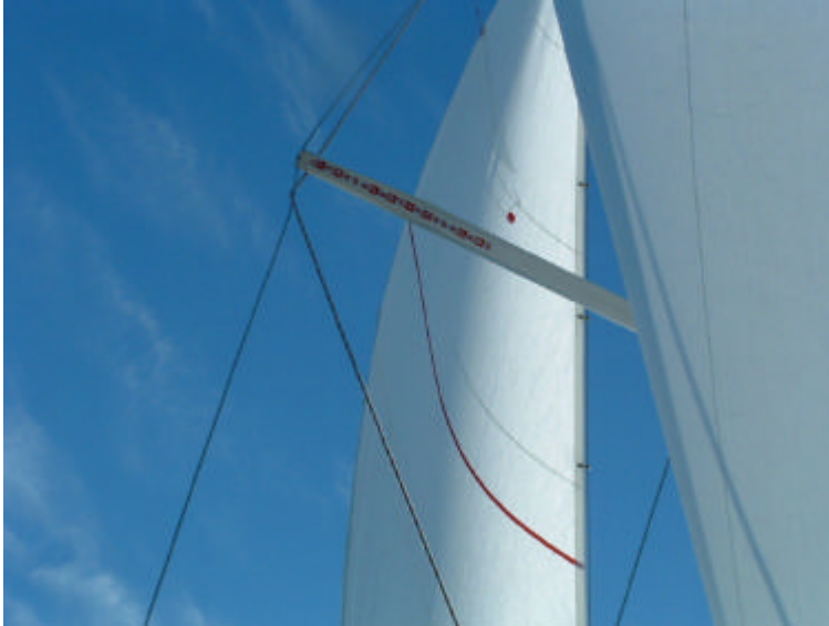
Bild 4 - Exempel på trimskala under spridare
